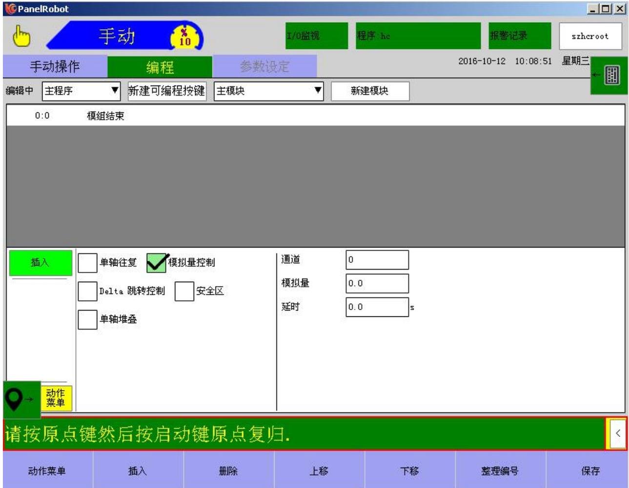
模拟量控制：勾选选择框后才可以对模拟量进行设置。（提示 1:使用此功能前要先勾选模拟量使能在第 4.2.3 章节有说明。提示 2:模拟量的调节可在自动状态下的“周期，产量计数器显示”按钮操作。）
