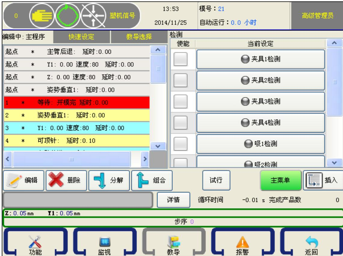
点击【检测】按钮可进入吸盘、夹具检测动作的教导页面，教导夹具和吸盘的动作后，点击需要检测确认信号的程序步后，再点击对应的夹具和吸盘动作按钮，使其指示灯变成红色，再点击 使其变成，再点击【插入】按钮将该检测程序插入到所选择程序步的前面，程序从此步开始检测夹具和吸盘的确认信号。
