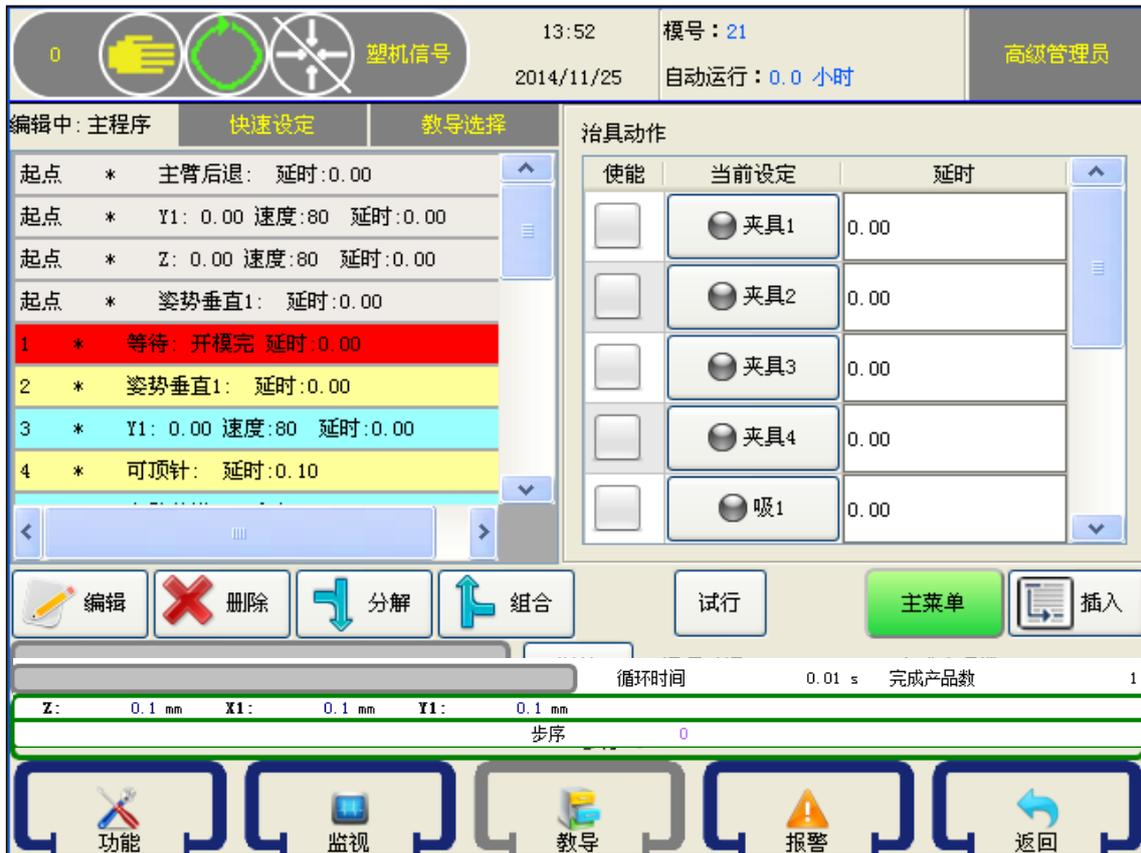
控制器可控制有四组夹具和四组吸盘动作，点击所要控制的夹具或吸盘按钮，该夹具或吸盘即输出同时按钮上的指示灯即变成红色。再点击左边的使其变成, 再点击【**插入**】按钮将该动作插入到所选择程序步的前面。
