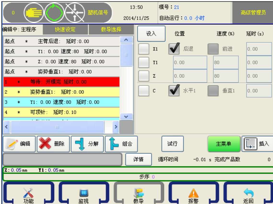
在该页面可对 X1、Y1、Z 轴的位置、动作速度、延时时间进行设定，点击轴左边的  使其变成图标 ，然后设定好该轴的参数，选中页面左边的程序步，再点击【插入】按钮即可将所编辑的轴动作插入到所选中程序步的前面。
