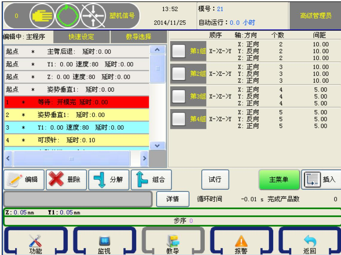
选中要插入的堆叠程序组左边的方框，如选择第2组堆叠程序，再点击【插入】按钮将该组堆叠程序插入到要开始堆叠的程序步前，自动运行时，机械手即按照此堆叠程序堆叠排放产品。如果要使用Y轴进行堆叠时，务必将堆叠程序插入到Y轴下降动作之前一步。
