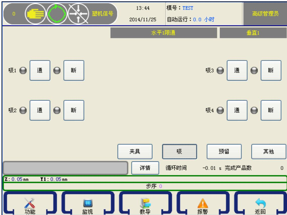
吸盘有四组，点击按钮【通】即相应的吸盘动作，点击按钮【断】即相应的吸盘断开动作。
