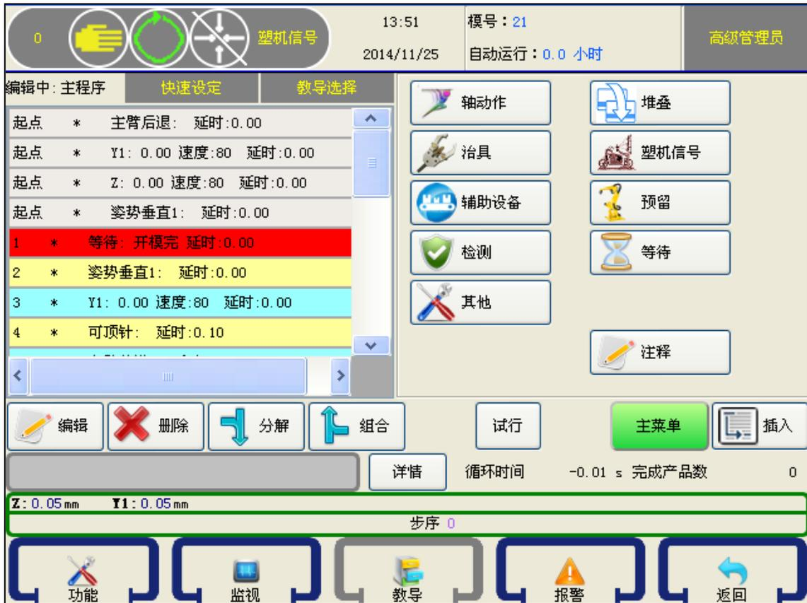
上图所示程序 4 步“起点”程序步为 4 个轴的起始位置和状态，新建一个程序已默认包含此四步程序起始点，每一个自动程序必须包含此四步步序，不可对其进行删除，只可以进行修改，点击所要修改位置再点击【编辑】键即可修改各轴的起始位置、动作速度和延长时间。
